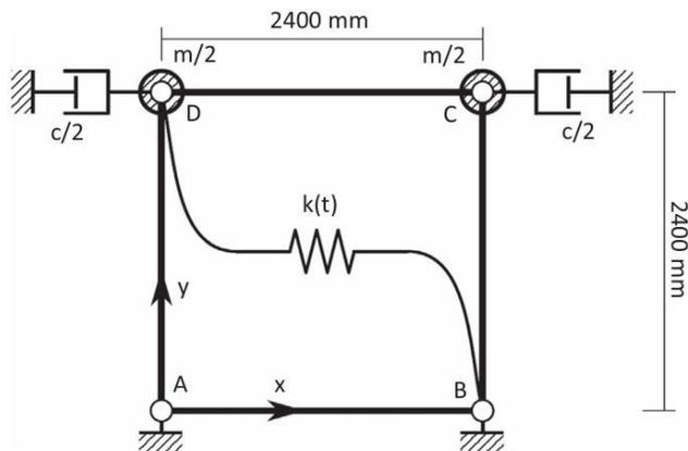
FIGURA 9. Modelo de elementos finitos simplificado propuesto por Boudaud et al. [37]
