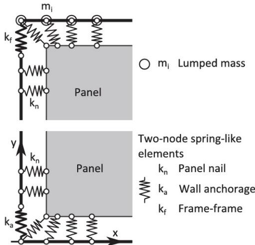
FIGURA 8. Enfoque de modelado basado en elementos finitos presentado por Humbert et al. [36]
