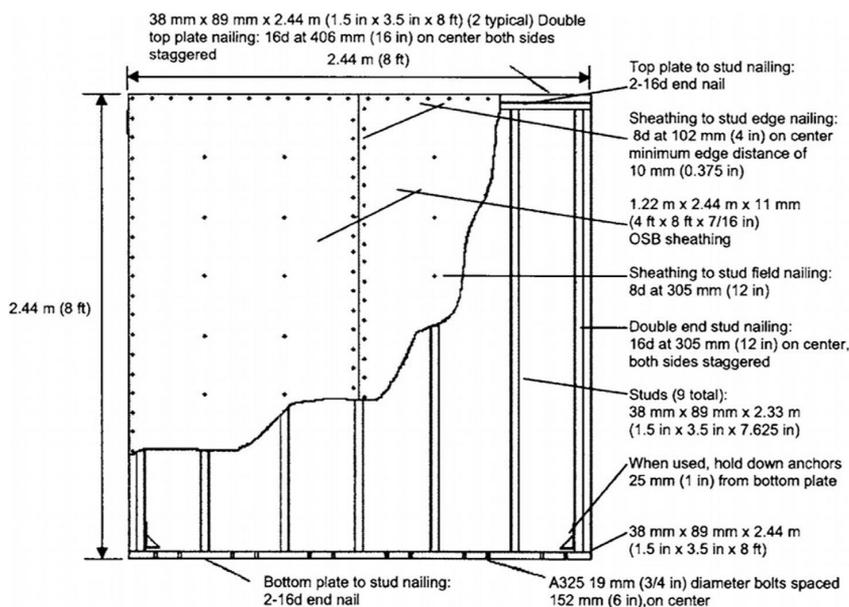
**FIGURA 1.** Geometría típica del muro de corte con entramado ligero de madera [6]
