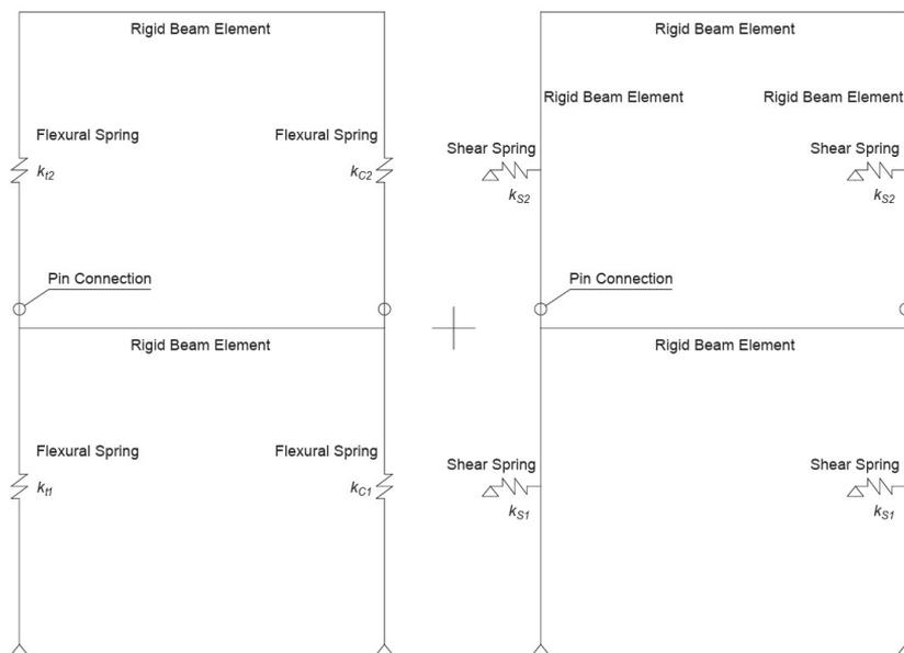
**FIGURA 10.** Modelo de elementos finitos simplificado propuesto por Peng et al. [38]
