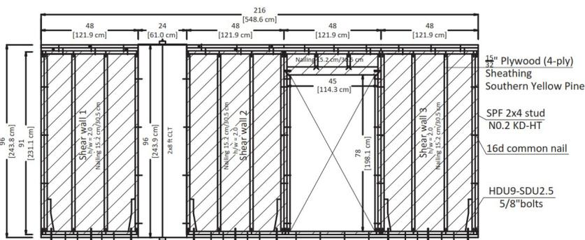
FIGURA 6. Sistema de muro híbrido CLT - Light frame [32].
